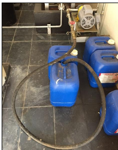
ภาพที่ 26 แสดงการเติมน้ำมันเชื้อเพลิงลงในถังพักโดยใช้ปั๊มเกียร์ (Gear pump)
