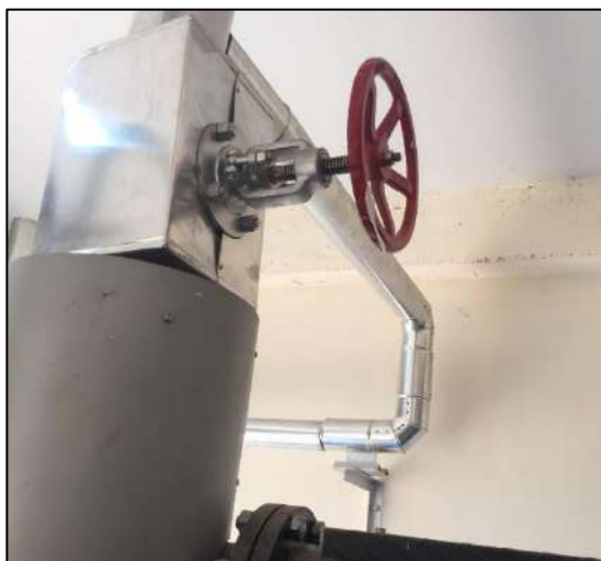
ภาพที่ 43 แสดงตำแหน่งจ่ายไอน้ำหลักของเครื่อง (Steam outlet)
