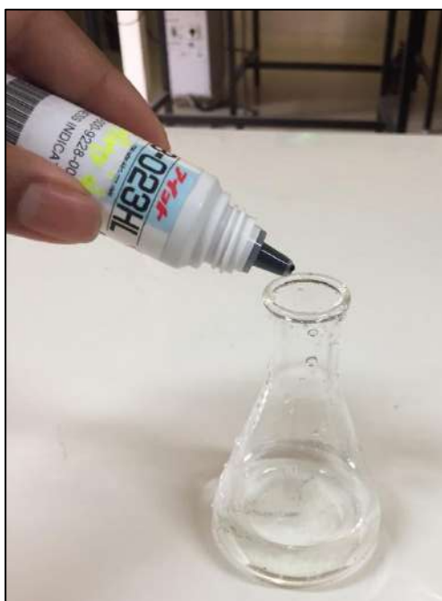
ภาพที่ 35 แสดงการหยดสารเคมีทดสอบคุณภาพน้ำ (Hardness indicator)
