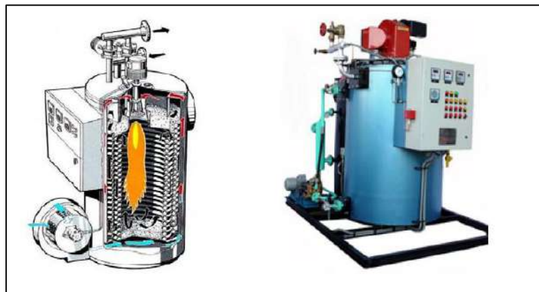
ภาพที่ 6 แสดงหม้อน้ำแบบท่อขดผ่านครั้งเดียว
