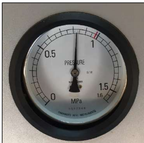
ภาพที่ 59 แสดงการทำงานของเกจวัดแรงดันแบบกลไก (Press gauge)
